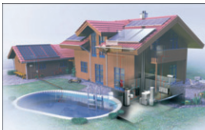
Bild 11 a: Für monokristalline Module spricht der etwas höhere Wirkungsgrad und der damit geringere Flächenbedarf
