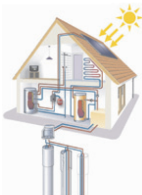
Bild 6: Wärmepumpenheizung mit Erdwärmesonde
