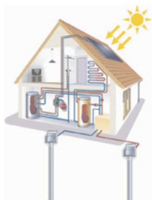
Bild 7: Wärmepumpenheizung mit Grundwassernutzung
