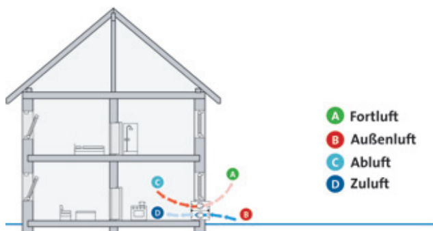
Bild 6: Dezentrales Lüftungsgerät mit Wärmerückgewinnung
