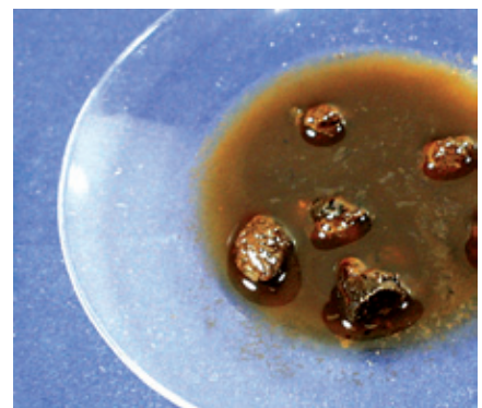
Zerstörtes Solarfluid mit unlöslichen Zersetzungsprodukten
