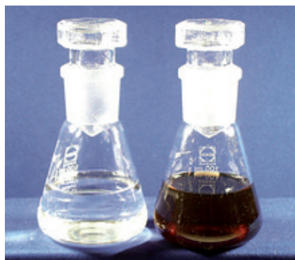
Solarfluid: Ausgangszustand (pH 8,2) und rechts stark gealtert (pH 6,8)
