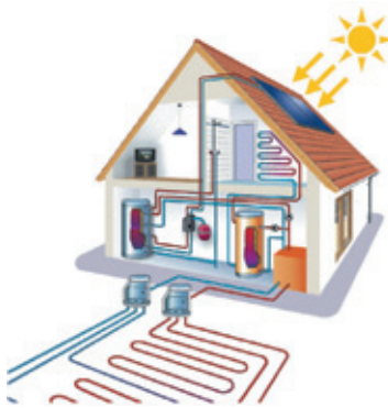
Bild 5: Wärmepumpenheizung mit Erdwärmekollektor
