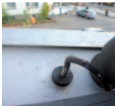
Bissspuren am Fühlerkabel
