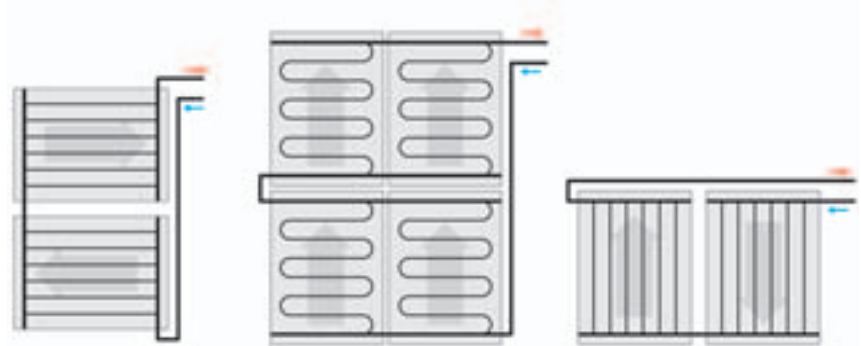
Leer kochendes Kollektorfeld mit von Kollektoranschlüssen steigenden Rohrleitungen
