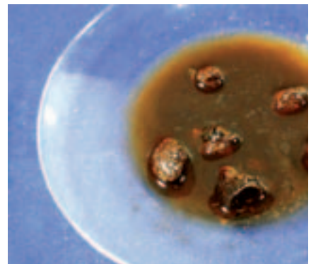
Zerstörtes Solarfluid mit unlöslichen Zersetzungsprodukten
