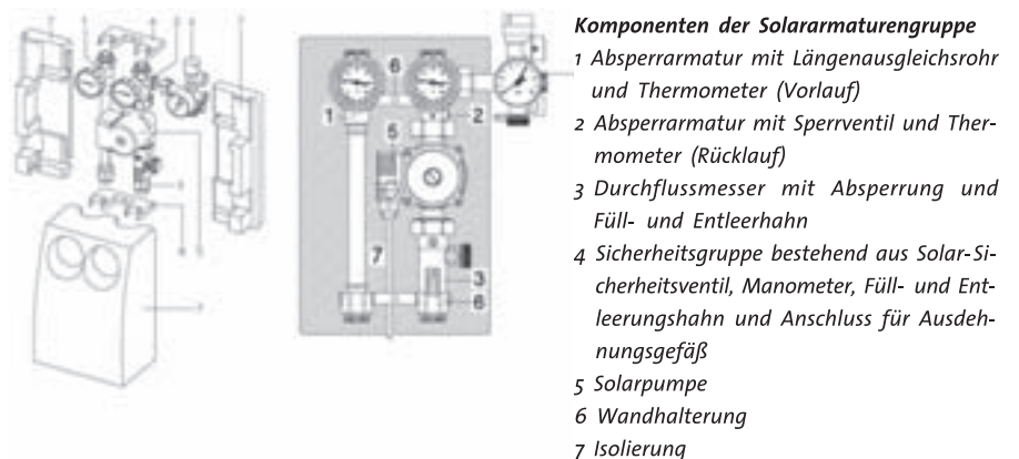
Bild 5: Vorkonfektionierte Solarstationen vereinfachen die Montage
