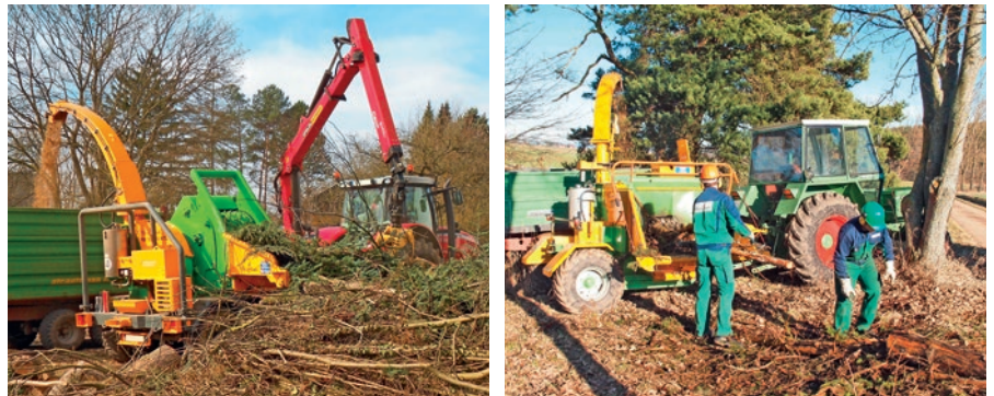
Bild 10: Kran- und handbeschickte Hackmaschine im Einsatz
