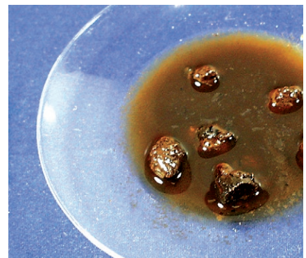
Zerstörtes Solarfluid mit unlöslichen Zersetzungsprodukten
