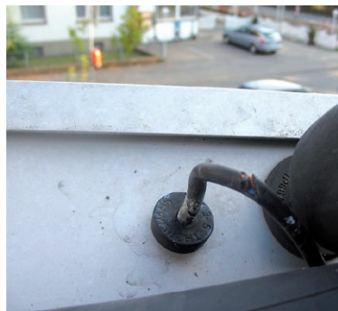
Bisspuren am Fühlerkabel
