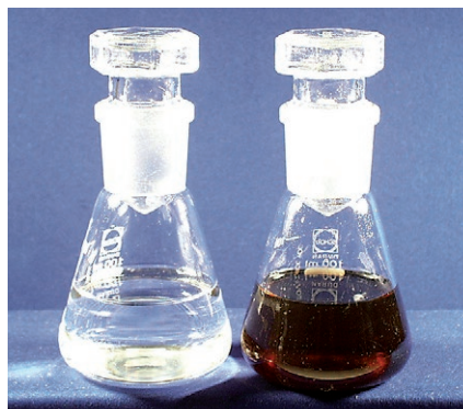
Solarfluid: Ausgangszustand (pH 8,2) und rechts stark gealtert (pH 6,8)
