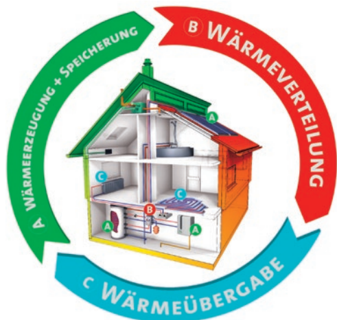
Bild 02: Komponenten eines Heizsystems im Einfamilienhaus.
