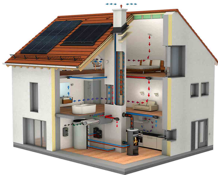
Ein modernes, flexibles Schornsteinsystem ist, wie in der Systemdarstellung aufgezeigt, die Basis wie auch das Bindeglied bei der Berücksichtigung verschiedener Gebäudestandards, Haustechniken und Ausbaustufen wie z. B. Heizung, Lüftung.
